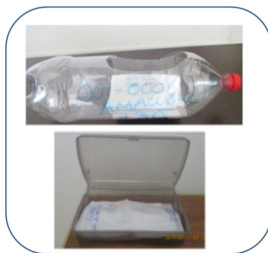
Figura 10. Recipiente reciclable, para transportar las papeletas que adquiere características de una cámara húmeda.
